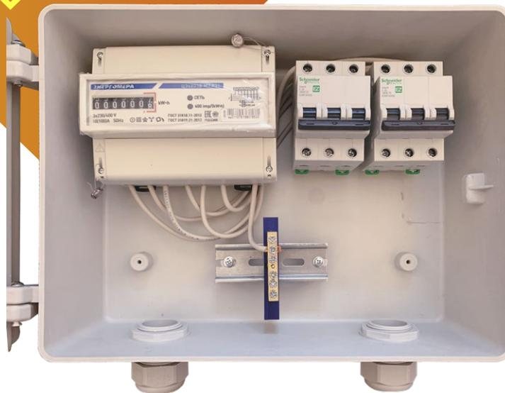
Антивандалное исполнение достигается конструкцией корпуса, свойствами материала (характеристика IK10 - выдерживаемая энергия удара 20 Дж или падение 5 кг гири с высоты 0.5 м), замками с личинкой треугольного профиля с дополнительной проушиной для навесного замка или пломбировки.
